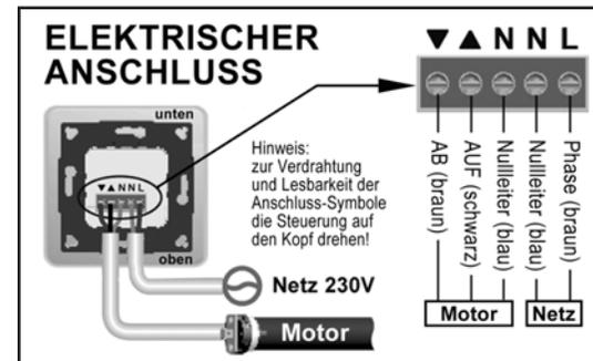
Schließen Sie die Steuerung gemäß dem Anschlussplan an das Versorgungsnetz und an den Rohrmotor an.
