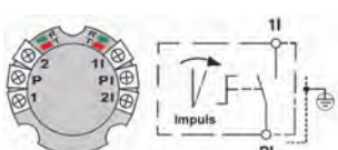
Bild 2 + 5 : S-APZ / EPZ 1-2T(R) 2-poliger Anschluss 2 Befehle tastend o. rastend
