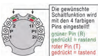
Bild 3 + 6 : S-APZ / EPZ 1-1R Anschluss 1 Befehl rastend
