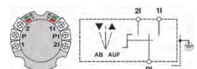
Bild 2 + 5 : S-APZ / EPZ 1-2T(R) Anschluss 2 Befehle tastend o. rastend
