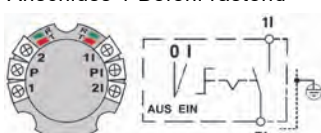
Bild 3 + 6 : S-APZ / EPZ 1-1R Anschluss 1 Befehl rastend
